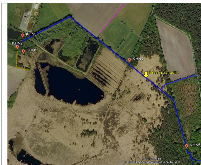
Figuur 48 Locatie van de bres in de zanddijk waardoor veel water uit de Nol stroomt
